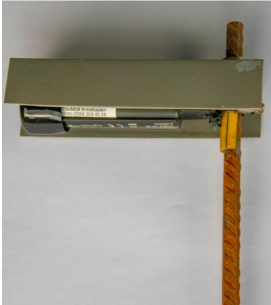
Abbildung 13: Am Metallstab befestigter Datenlogger mit Sonnenabdeckung.
